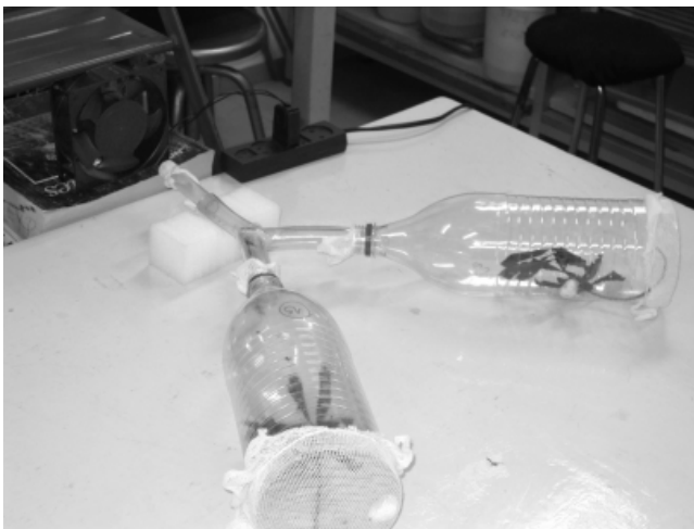
Fig. 1. Procedimiento experimental: un ventilador aspiraba el aire desde la base de un tubo en "Y" donde se colocó el macho. Por los brazos de la "Y" se conectaron dos recipientes con ramas de "Canelón" sin nido o control (C), con nido de hermanos (H) o con nido de no hermanos (NH).
